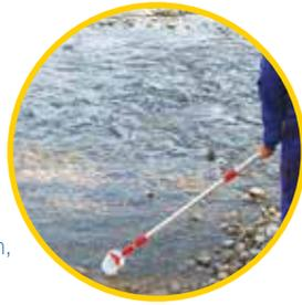
Pendelbecher, schwingt in die horizontale Position, ideal für den Zugriff in tiefen und engen Schächten (Durchmesser 150 mm)
