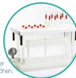
Thermo Scientific™ HyperSep™-Glasblockverteiler bieten eine einfache Möglichkeit zur schnellen Bearbeitung mehrerer Proben. Der starre Corian-Deckel des Verteilers widersteht einer Krümmung und ermöglicht das direkte Eluieren der Proben in die Einweg-Reagenzgläser. Das Design ermöglicht die Sichtprüfung der Extraktion und erleichtert die Reinigung.
