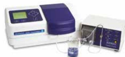
Für weniger sensible Anwendungen mit einem größeren Wellenlängenbereich ist Modell 6270 geeignet. Modell 6280 ist für die empfindlichsten Bestimmungen mit Emissionswellenlängen bis zu 650 nm geeignet. Modell 6285 verfügt über einen rotverstärkten Detektor und ist für höhere Emissionswellenlängen geeignet.
