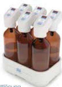
Das Instrument bietet dem Benutzer eine Komplettlösung. Es ist sofort für die Messung des BSB auf vier Skalen einsatzbereit: 90 ppm, 250 ppm, 600 ppm und 999 ppm. Die zu untersuchende Probemenge variiert von 100 ml bis 400 ml, bei einer Gesamtkapazität der Flasche von 500 ml.
